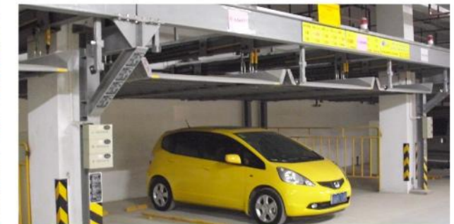
四立柱简易升降车库—广西柳州阳光100城市广场
